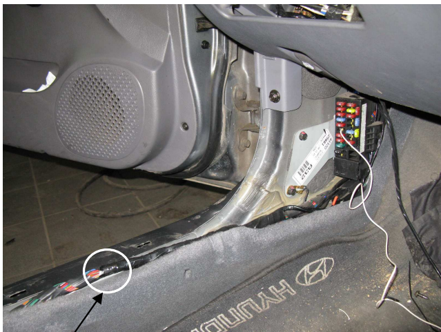
Место подключения входов стража к концевикам дверей и багажника.
